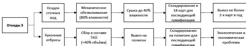
Рис. 8. Схема обращения с ОСВ и кухонными отбросами в городе Уфе
