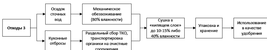
Рис. 10. Схема переработки «отходов 3» с запуском нового оборудования
